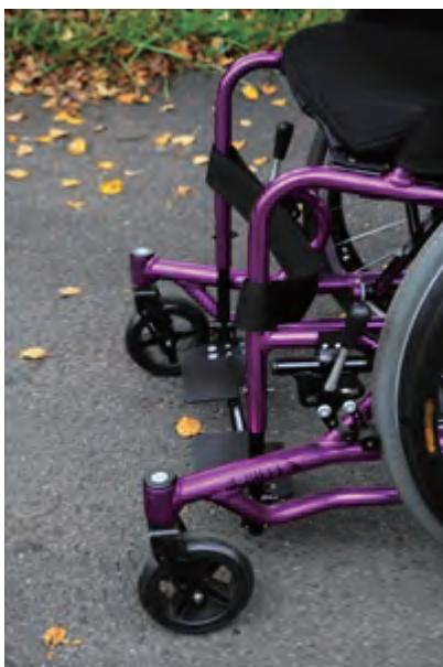
一般的な車いすより、フットサポートが手前に引き込んだ位置にある。膝の角度が開いていると起きやすくなる痙攣を抑えるための工夫。
