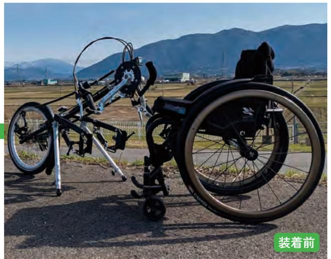
ハンドサイクルは、大きく分けてアダプター式とスポーツタイプの2種類。アダプター式(写真上2点)は、本体を日常的に使用している車いすに装着することで、自転車としての機動力が備わります。
