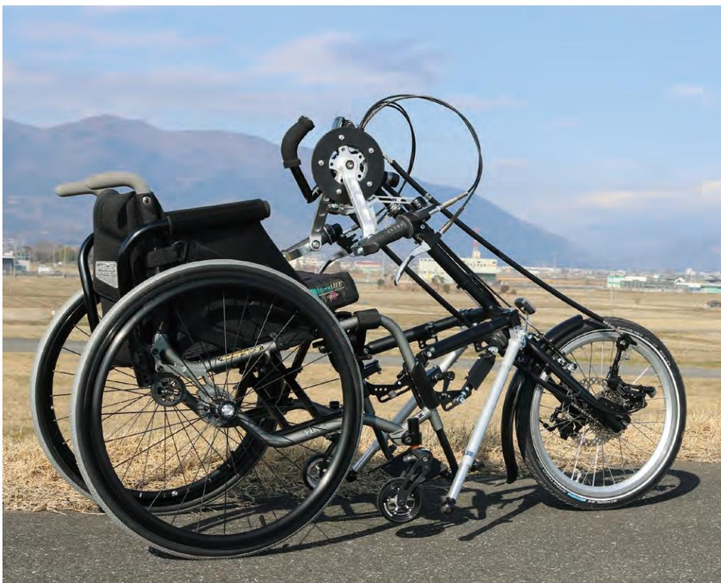
腕でクランクを回し、ギヤとチェーンに動力を伝えて駆動輪を回転。構造は一般的な自転車と同じです。
