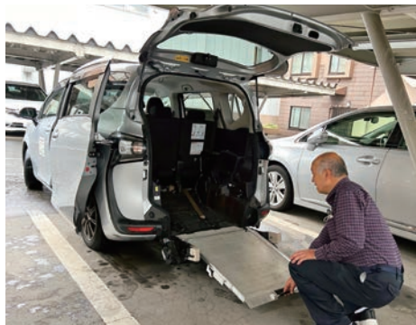
札幌微助人倶楽部が所有する車いす対応車両(リフト付き)
