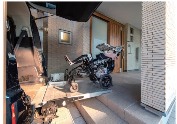
カーポートに収めた車からリフトを出して、バギーに乗った優さんを安全・安心に乗・降車。玄関スロープは幅1.3mを確保。積雪期もバギーで出かけられる。
