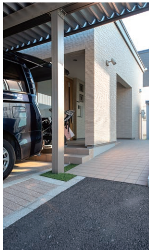
カーポートに収めた車からリフトを出して、バギーに乗った優さんを安全・安心に乗・降車。玄関スロープは幅1.3mを確保。積雪期もバギーで出かけられる。
