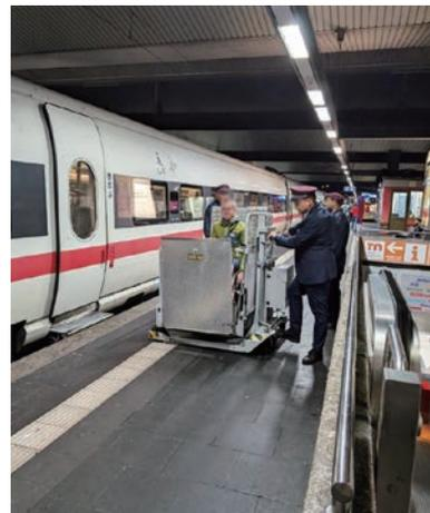
車いすユーザーが安全・安心に電車に乗降できるよう、駅に設置された移動式段差解消機
